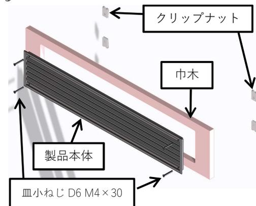
2. 巾木に製品本体を取り付ける時、クリップナットの向きに注意し、しっかりと固定する。
