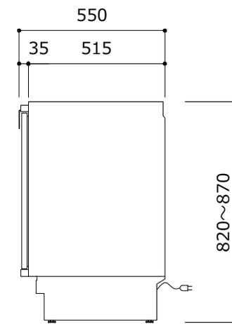
**ビルトイン専用冷凍冷蔵庫 - 仕様・外形寸法図**
