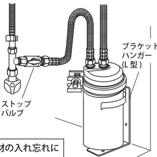
⚠ パッキンやシールテープなど、シール材の入れ忘れに注意して施工してください。また、施工後は必ず漏水検査を行ってください。
